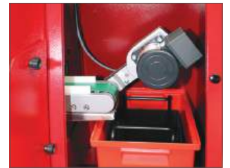
零件分离器+零件输送带+零件收集盒 Récupérateur de pièce + Sortie de pièce sur bande + Bac de récupération de la pièce Workpiece separator + workpiece discharge onto belt + workpiece collecting bucket 0125-61310-000 / 0125-61370-000
